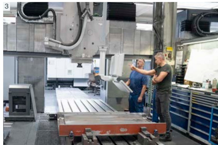
2. Die veraltete Maschinensteuerung (oben vorne im Bild) wird, genau wie die Software, auf den neusten Stand gebracht
