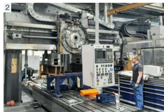
3. Dank der neuen Maschinensteuerung mit intuitiv bedienbarem Touchpanel und einer maschinenübergreifenden Software zur Bearbeitung verschiedenster Werkstücke ist die Portalfräsmaschine nun für die kommenden Jahre ausgestattet
