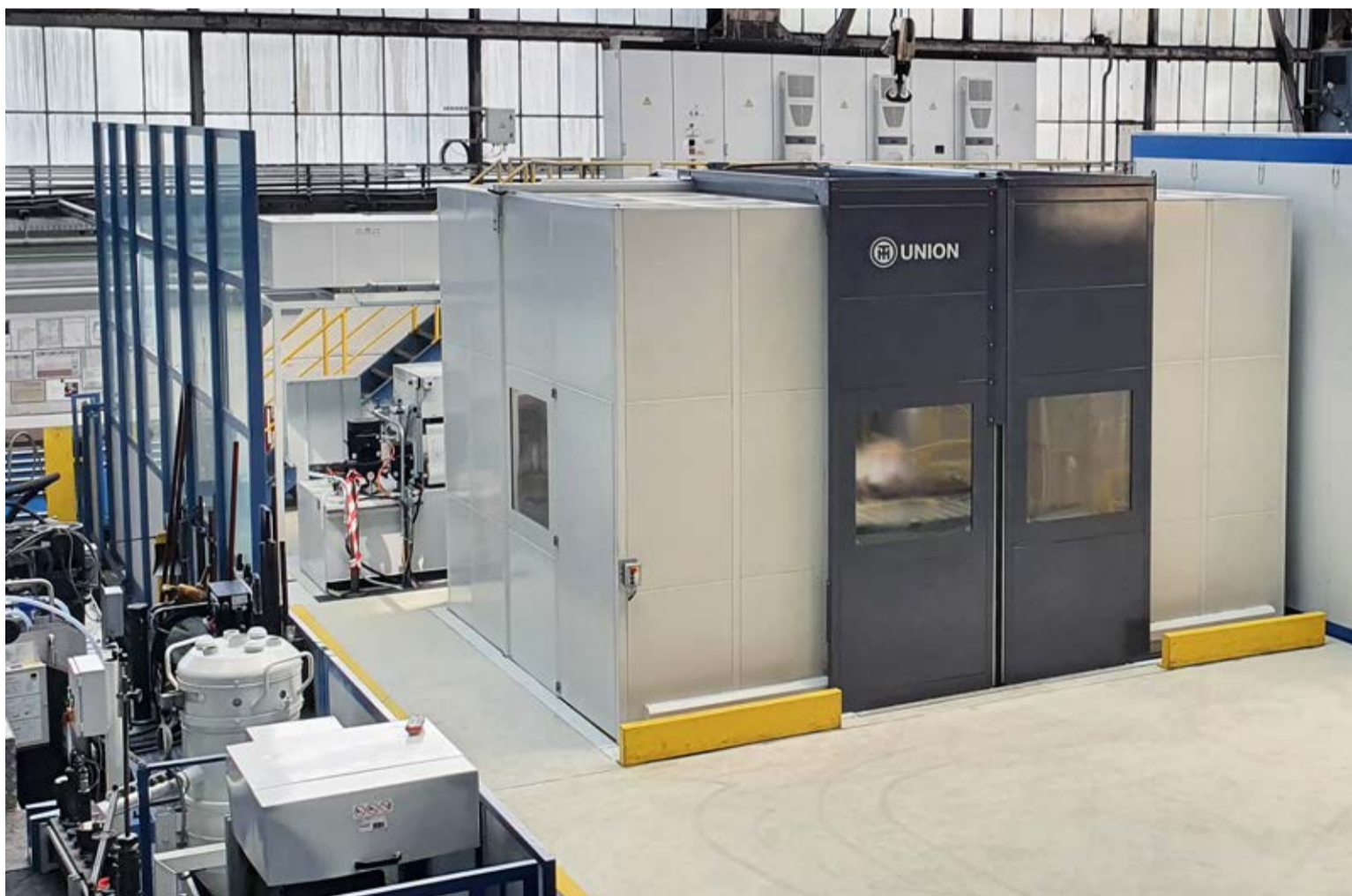
Die CNC-Horizontal-Bohr- und Fräsmaschine der T-Serie für die effektive und kostengünstige Bearbeitung von mittelschweren Werkstücken (bis 10 t) mit einem Arbeitsraum von bis zu 2.500 × 2.000 × 1.600 mm
