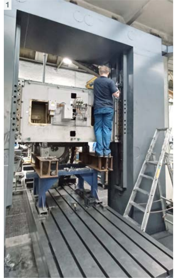
1. Wichtige Komponenten und Verschleißteile der Portalfräsmaschine wurden gewissenhaft von unseren Experten geprüft und überarbeitet
